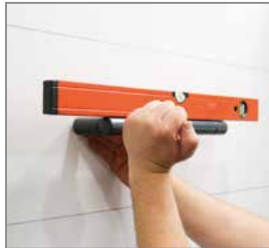
Enkel justering av handtaget. Ett enkelt slag på handtaget markerar det andra borrhålet.
