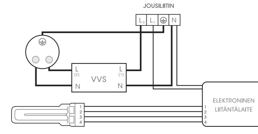
**HUOM!** Jos valolle ja pistorasialle ei ole erikseen omaa ryhmäjohtoa, on  $L_1$  ja  $L_2$  yhdistettävä johdinlenkillä ( $0,5 \text{ mm}^2$ ).
